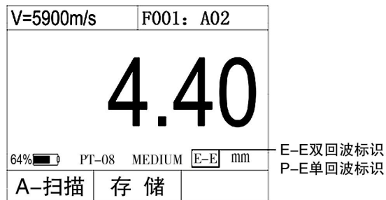
图 3.7 穿透涂层模式厚度测量界面
